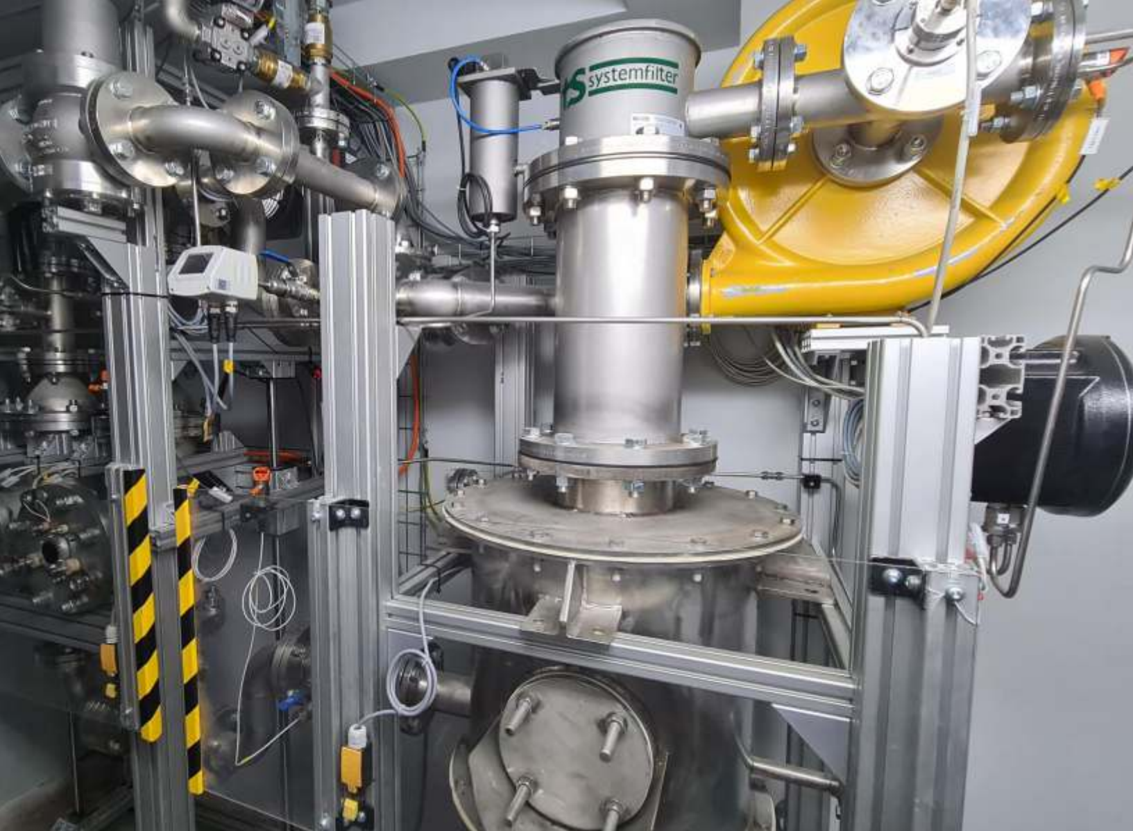
Entstaubungsfilter von ts-systemfilter im Plasmalyse-Verfahren der Graforce GmbH integriert Dedusting filter from ts-systemfilter integrated in the Graforce GmbH plasmalysis process
